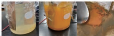
図2. 実験1「銅板を用いた塩化ナトリウム水溶液の電気分解」 左: 実験開始直後(陰極(左の板)から気体が発生している) 中: 実験開始1時間後 右: 乾燥させた沈殿を撮った
